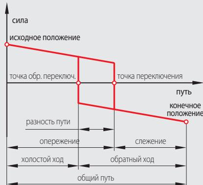
**Опережение** Максимальный путь приводного элемента между исходным положением и точкой переключения, при котором коммутирующие устройства еще не движутся.
