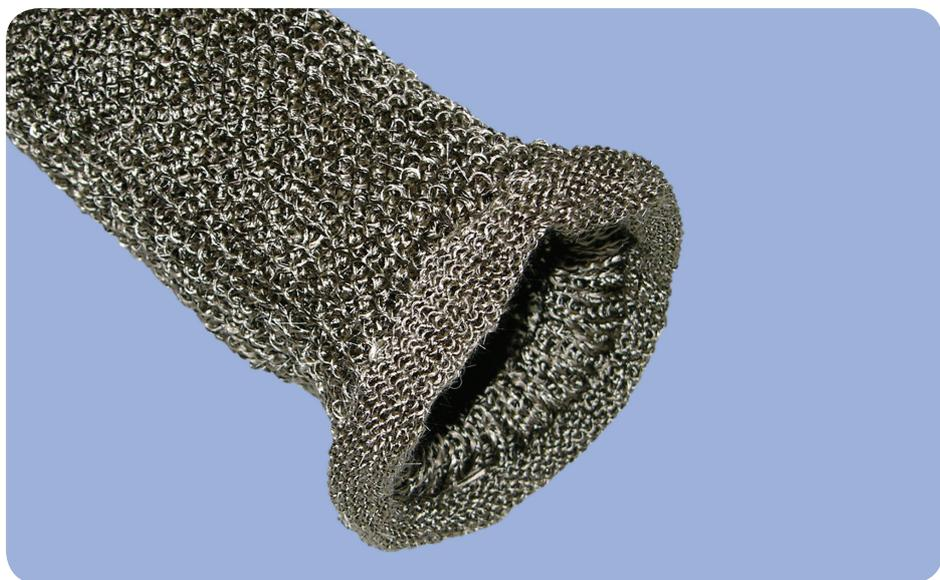
**ThermFlex® 1224** это плетеная трубка, предназначенная для изоляции высокотемпературных выхлопных систем. ThermFlex® 1224 изготовлен из базальтовых нитей, и потому может выдерживать температуры до 750°C.
